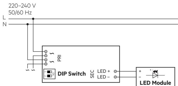
Gerät mit Durchgangsverdrahtungsfunktion.
